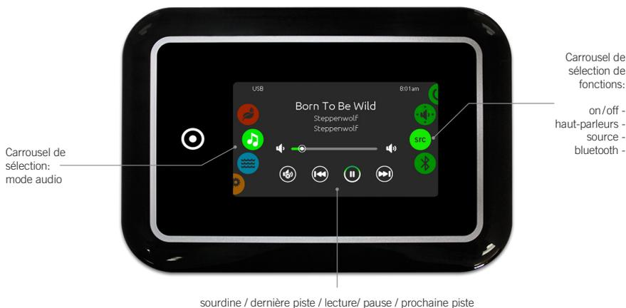
Pour sélectionner le mode audio, faites tourner le carrrousel gauche vers le haut ou vers le bas jusqu'à ce que l'icône du mode audio s'allume au milieu de l'écran.
